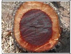
El quebracho colorado tiene una madera persistente, casi imputrescible, por lo que se utiliza en ebanistería y en muebles de calidad. y fue la principal madera para confeccionar postes y los rectangulares y longilíneos "durmientes" que soportan los rieles de los ferrocarriles en gran parte de Argentina.
